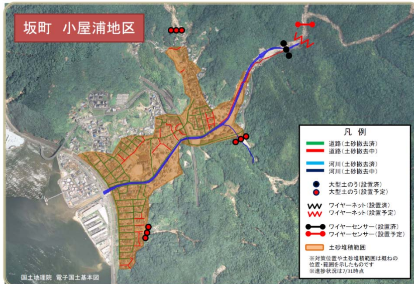
図 3-7 坂町小屋浦地区の土砂災害分布と応急復旧計画
