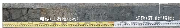
ジオスライサーによる連続採取試料(GS-10)と含有炭化物
