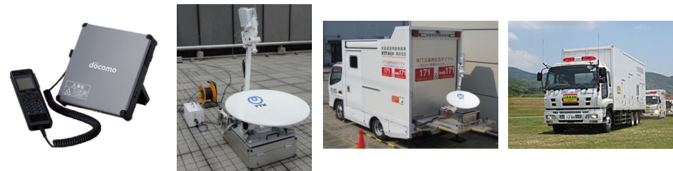
左から衛星可搬端末、ポータブル衛星装置、同車載型、電源車(1000KVA)
