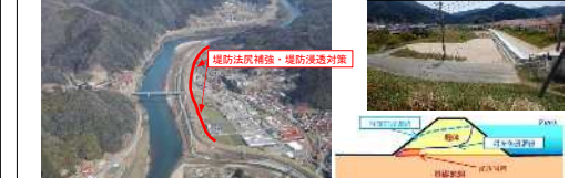
堤防強化が必要な箇所
